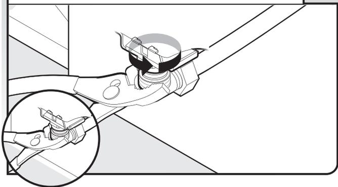
S'assurer que la rondelle de caoutchouc est correctement installée dans le raccord. Enfiler le raccord de 3/4" vers le haut jusqu'à la valve et serrer à la main afin d'éviter de fausser le filetage. Serrer à la main jusqu'à ce que le raccord soit serré.
