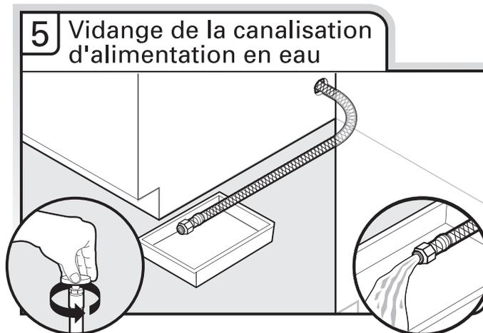
Tourner lentement le robinet d'arrêt jusqu'à la position "ON" (marche). Vider l'eau dans un plat peu profond pour éliminer les particules et débris qui pourraient obstruer l'électrovanne d'admission. Tourner le robinet d'arrêt jusqu'à la position "OFF" (arrêt).
