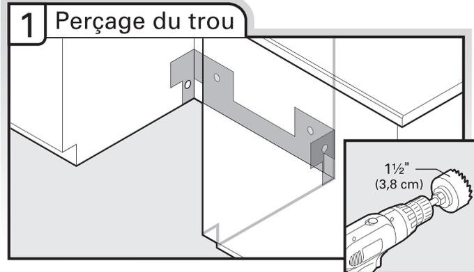
Si nécessaire, percer un trou de 1 1/2" (3,8 cm) de diamètre dans la paroi du placard ou l'arrière de le côté la plus proche de l'évier.
