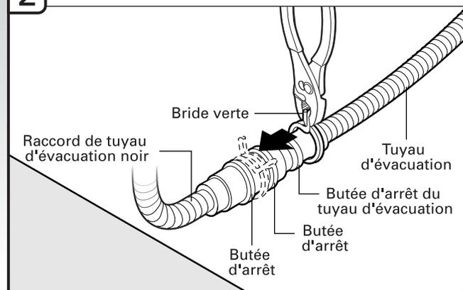
À l'aide d'une pince, ouvrir la petite bride de tuyau d'évacuation en la serrant et la faire glisser sur le connecteur, entre les butées.
