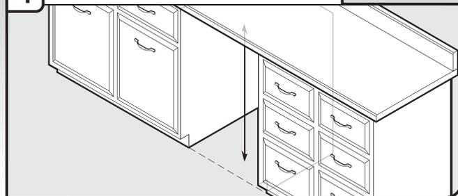
Mesurer la hauteur de l'ouverture d'encastrement du placard entre le dessous du plan de travail et le plancher, à l'emplacement d'installation du lave-vaisselle (la mesure doit être prise entre le point le plus bas depuis le dessous du plan de travail et le point le plus haut du plancher). Consulter le "Tableau de réglage de la hauteur du lave-vaisselle" pour ajuster les pieds de nivellement.
