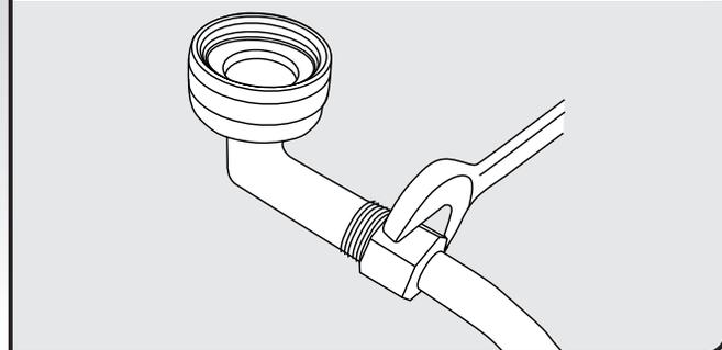
Raccorder le raccord de compression de  $\frac{3}{8}$ " à la canalisation d'alimentation en eau avant d'installer l'appareil dans l'ouverture découpée dans le placard. Le fixer de façon à ce que le raccord de  $\frac{3}{4}$ " soit orienté vers le haut, tel qu'illustré ci-dessus.
