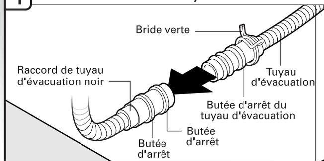
Placer une serviette sous le tuyau d'évacuation pour récupérer l'eau restée dans le tuyau d'évacuation. Placer la petite bride pour tuyau d'évacuation sur la petite extrémité du tuyau d'évacuation. Enfoncer le tuyau d'évacuation neuf dans le connecteur noir de tuyau d'évacuation jusqu'à la butée d'arrêt du tuyau d'évacuation.
