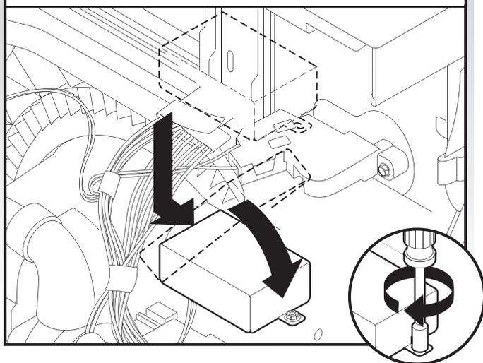
Placer les conducteurs à l'intérieur du boîtier de connexion. Insérer les languettes du côté gauche du couvercle. S'assurer que les fils sont bien logés à l'intérieur du boîtier. Fermer le couvercle tout en veillant à ne pas coincer de fils. Fixer le couvercle à l'aide d'un tourne-écrou de 1/4" ou d'un tournevis Torx® T20® et de la vis précédemment retirée.
