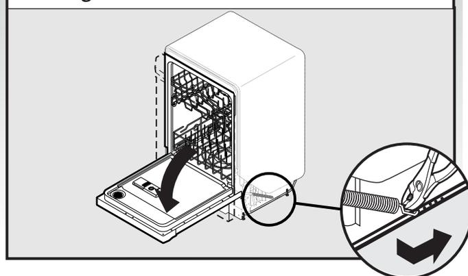
Lorsque la porte s'ouvre d'elle-même, augmenter la tension du tendeur en déplaçant l'extrémité du ressort vers l'arrière du lave-vaisselle.
