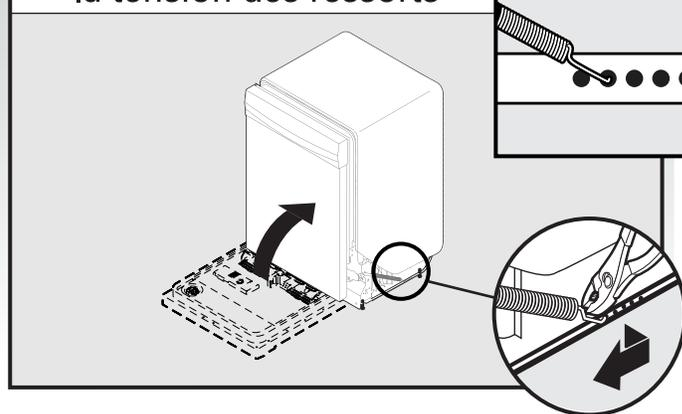
Si la porte se ferme trop rapidement, réduire la tension des ressorts : déplacer le point d'ancrage de l'extrémité du ressort vers l'avant du lave-vaisselle.
