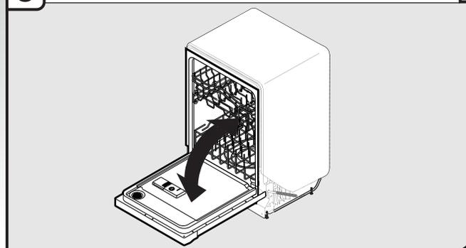
Alors qu'une autre personne retient l'appareil pour l'empêcher de basculer, ouvrir et refermer la porte plusieurs fois. Si la porte se ferme ou s'ouvre sous l'effet de son propre poids, il sera nécessaire d'ajuster la tension du ressort de la porte.
