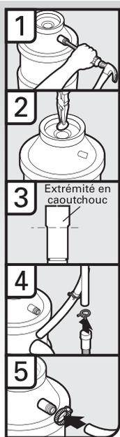
1. À l'aide d'un marteau et d'un tournevis, enfoncer le bouchon d'obturation dans le broyeur à déchets.
