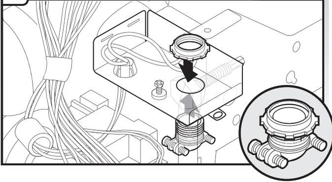
Installer un serre-câble (homologation UL ou CSA). Veiller à ce que les têtes de vis soient orientées vers la gauche après le serrage de l'écrou du serre-câble. Le serre-câble est fourni avec le cordon d'alimentation.
