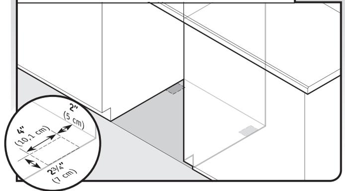
Planchers surélevés : (si la hauteur du plancher de la cuisine est supérieure à celle de l'ouverture d'encastrement du placard), par exemple : le carrelage du plancher de la cuisine n'arrive pas jusque dans l'ouverture du placard, ajouter des cales selon le besoin dans la zone indiquée pour placer le lave-vaisselle à une hauteur maximale de 33 $\frac{1}{2}$ " (85,1 cm) sous le plan de travail.
