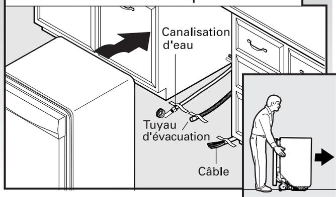
**IMPORTANT :** Vérifier que le câblage est installé au bon endroit. Saisir les côtés du lave-vaisselle par les rebords du panneau de porte. Approcher l'appareil de l'ouverture dans le placard.
