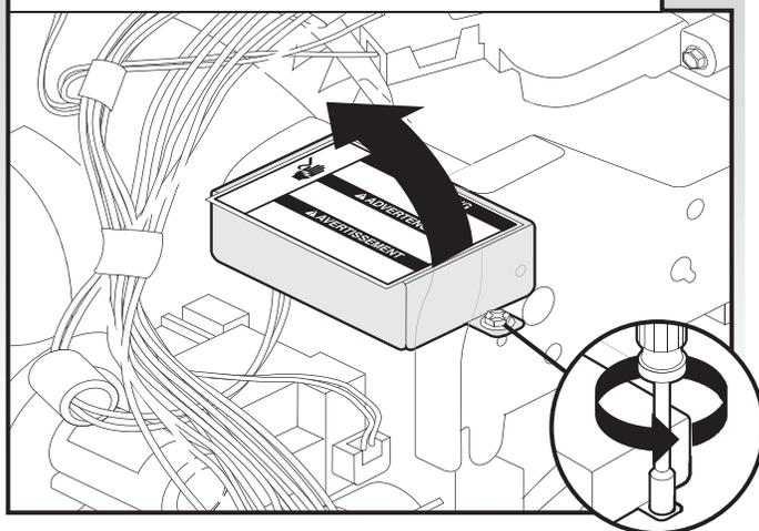
Utiliser une clé à douille hexagonale, un tourne-écrou de 1/4" ou un tournevis Torx® T20®; démonter le couvercle du boîtier de connexion; conserver les pièces pour réutilisation éventuelle.
