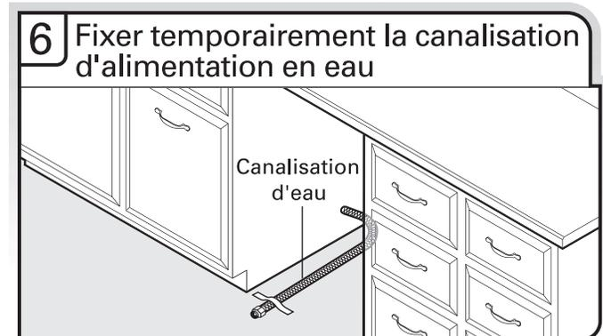
Installer la canalisation d'alimentation en eau et la fixer au plancher avec du ruban adhésif dans la zone indiquée. Cela l'empêchera de bouger lors de l'insertion du lave-vaisselle dans l'ouverture du placard.
