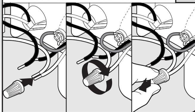
**REMARQUE :** Ne pas pré-torsader les brins des conducteurs. Installer un connecteur de fils (homologation UL ou CSA). Tirer doucement sur les conducteurs pour vérifier qu'ils sont bien fixés.
