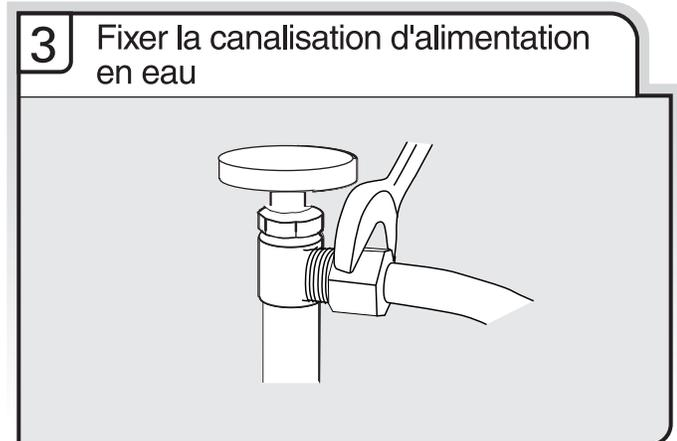
Fixer la canalisation d'alimentation en eau (tube de cuivre ou canalisation flexible à tresse d'acier) à la canalisation d'eau chaude à l'aide d'une configuration de raccordement qui soit conforme à tous les codes et règlements locaux. La canalisation d'alimentation en eau raccordée au lave-vaisselle doit comporter un robinet d'arrêt manuel situé sous l'évier.
