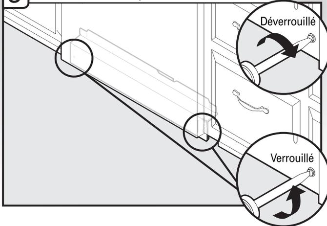
À l'aide d'un tournevis à lame plate, tourner les dispositifs de fixation d'un quart de tour pour les verrouiller. L'encoche du dispositif de verrouillage sera complètement à la verticale lorsqu'elle est correctement verrouillée.
