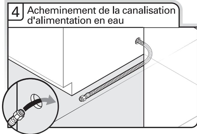
Faire passer prudemment la canalisation d'alimentation en eau à travers le trou percé dans le placard. (Le tube de cuivre peut s'écraser/se déformer facilement lors d'une flexion; procéder prudemment.) Il faut que la longueur de la section qui dépasse dans l'espace d'encastrement soit suffisante pour le raccordement à l'entrée du lave-vaisselle sur le côté gauche/à l'avant du lave-vaisselle.
