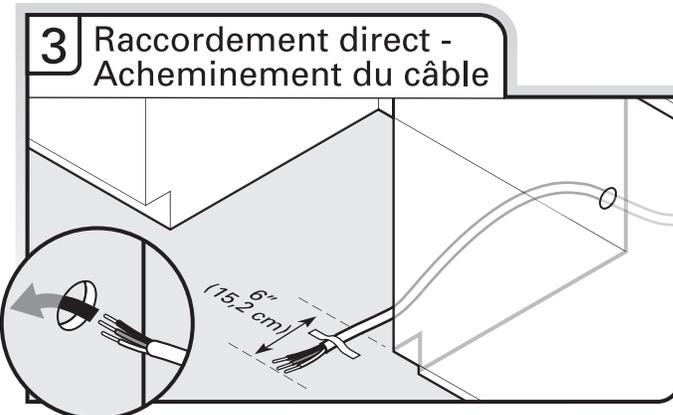
Acheminer le câble de la source d'alimentation électrique à travers le trou dans le placard (le câble doit dépasser par le côté avant droit de l'ouverture d'encastrement du placard). Fixer le câble au plancher avec du ruban adhésif dans la zone indiquée. Cela empêchera le câble de bouger lors de l'insertion du lave-vaisselle dans l'ouverture du placard.
