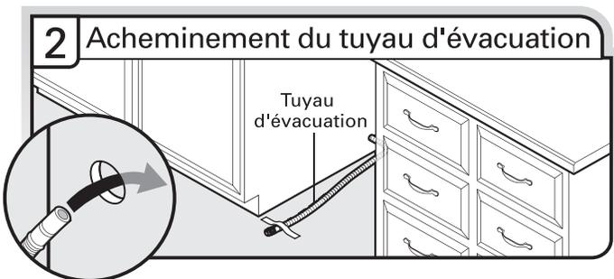
Insérer le tuyau d'évacuation tel qu'indiqué à travers le trou dans le placard et l'acheminer jusqu'au point de raccordement du tuyau d'évacuation (au centre de l'ouverture, à l'avant). Fixer le tuyau d'évacuation au plancher avec du ruban adhésif dans la zone indiquée. Cela l'empêchera de bouger lors de l'insertion du lave-vaisselle dans l'ouverture du placard.
