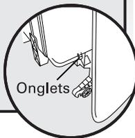
En utilisant les fentes précoupées dans l'isolation, fixer l'excédent d'isolation sur les crochets moulés sur la cuve. Veiller à fixer l'isolation sur les deux côtés de la cuve.
