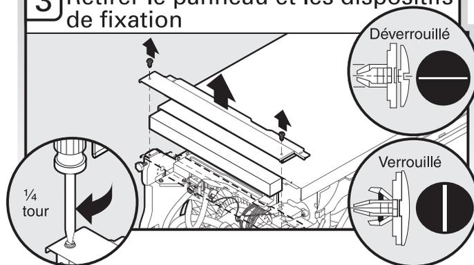
À l'aide d'un tournevis à lame plate, tourner les dispositifs de fixation en plastique d'un quart de tour pour les déverrouiller. Retirer le panneau. Ne pas retirer la fiche technique du panneau d'accès.
