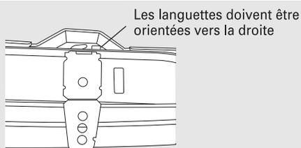
Retirer les brides de l'emballage et les insérer dans les fentes ouvertes sur les côtés supérieurs droit et gauche du collet du lave-vaisselle, tel qu'indiqué.
