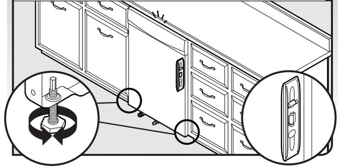
Vérifier que chaque pied de réglage de l'aplomb est fermement en appui sur le sol. Fermer et verrouiller la porte; placer un niveau contre le panneau avant. Vérifier que le lave-vaisselle est centré de l'avant vers l'arrière dans l'ouverture. Si nécessaire, régler le pied de nivellement jusqu'à ce que le lave-vaisselle soit d'aplomb. Répéter ces opérations pour l'autre côté du lave-vaisselle.
