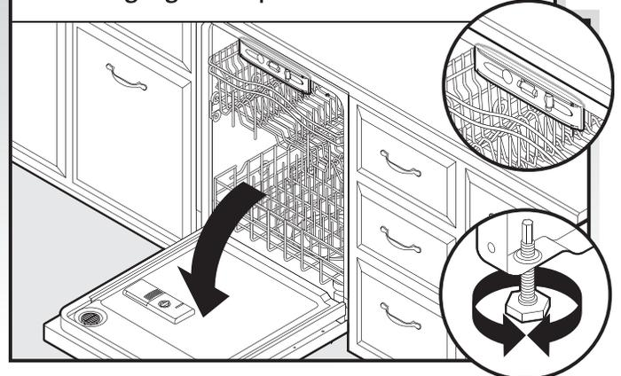
Placer le niveau contre la partie supérieure de l'ouverture avant de la cuve. Vérifier l'aplomb transversal de l'appareil. Si le lave-vaisselle n'est pas d'aplomb, régler la hauteur des pieds avant vers le haut ou vers le bas jusqu'à ce que le lave-vaisselle soit d'aplomb. Fermer la porte du lave-vaisselle.
